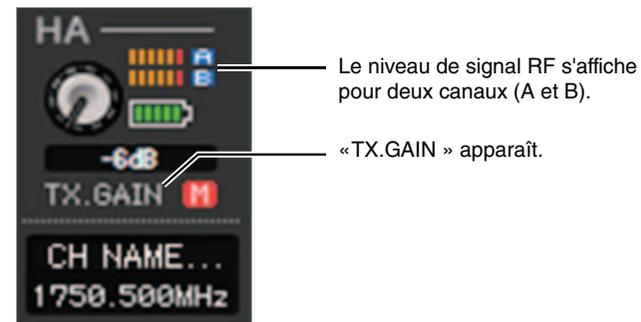
Lorsque le récepteur est activé et non connecté via une commande à distance ShowLink®
