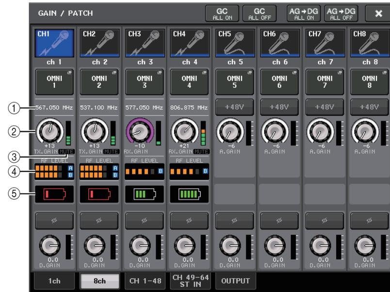
S'il existe une connexion de commande respectivement pour les périphériques AXT400 sur CH 1-2, QLXD4 sur CH3 et ULXD4 sur CH4.
