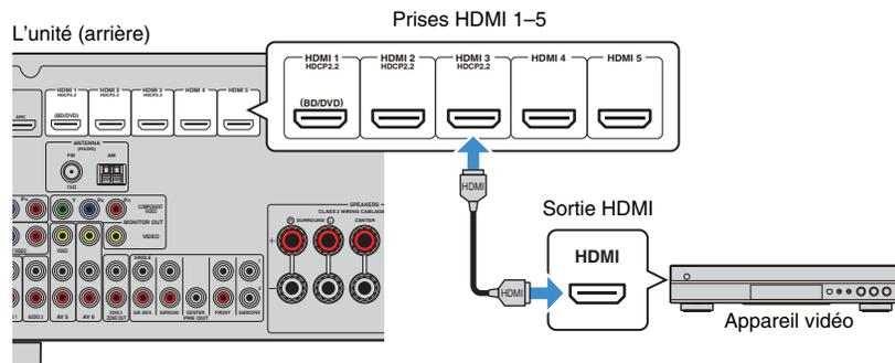
Si vous appuyez sur HDMI 1-5 pour sélectionner la source d'entrée, les signaux vidéo/audio lus par l'appareil vidéo seront restitués sur l'unité.
