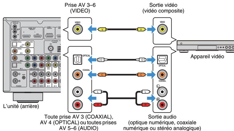
Si vous appuyez sur AV 3-6 pour sélectionner la source d'entrée, les signaux vidéo/audio lus par l'appareil vidéo seront restitués sur l'unité.
