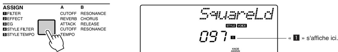
Le bouton A peut servir à régler la fréquence de coupure du filtre, et le bouton B la résonance.
