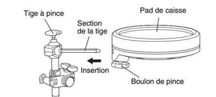
3. Si nécessaire, utilisez les boulons de pince A à E pour régler la hauteur et l'angle du pad de caisse claire. Prenez soin d'ajuster les boulons un par un (desserrez un boulon, ajustez le pad, puis resserrez le boulon avant d'en desserrer un autre).
