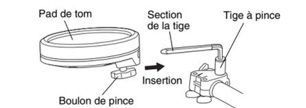
3. Si nécessaire, utilisez les boulons de pince A à D pour régler la hauteur et l'angle des pads. Prenez soin d'ajuster les boulons un par un (desserrez un boulon, ajustez le pad, puis resserrez le boulon avant d'en desserrer un autre).
