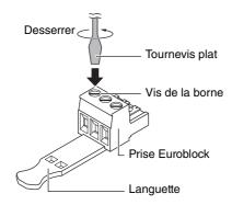
L'explication suivante utilise, à titre d'exemple, une prise Euroblock munie d'une languette.
