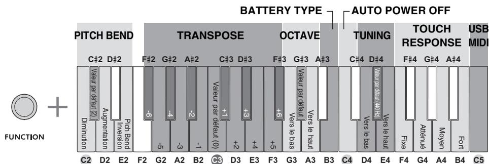
Les étiquettes figurant sous les touches à l'avant de l'instrument indiquent la fonction de celles-ci lorsqu'elles sont utilisées conjointement à la touche [FUNCTION].
