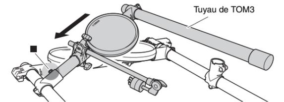
5. Serrez le boulon à clavette (en ■ sur la figure ci-dessus) situé sur le grand rack ainsi que le boulon de pince du support de cymbale.
