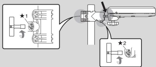
4. Ajustez l'angle du pad de caisse claire en desserrant d'abord le boulon à clavette (★ 1 et ★ 2 dans la figure ci-dessous). Serrez fermement le boulon à clavette après le réglage.
