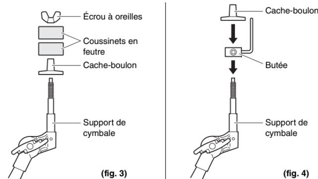
6. Disposez la butée de sorte qu'elle soit parfaitement en contact avec la surface inférieure du cache-boulon puis serrez le boulon à clavette à l'aide de la clé d'accord pour maintenir la butée en place (fig. 5).
