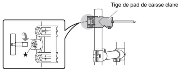
2. Serrez légèrement le boulon de pince dans la prise du pad de caisse claire. (Resserrez le boulon de pince de cinq à six tours.)
