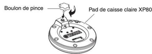
3. Fixez le pad de caisse claire XP80 sur la tige, puis serrez le boulon à clavette afin de maintenir le pad de caisse claire en place.
