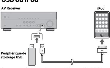
Connectez un périphérique de stockage USB ou un câble USB fourni avec l'iPod sur la prise USB de l'ampli-tuner audio-vidéo (en façade), de la façon illustrée.
