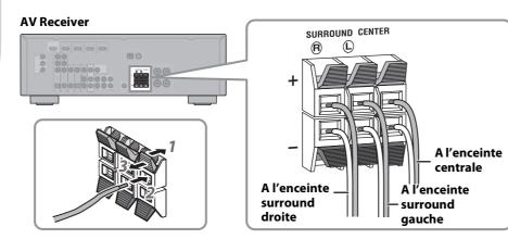
Raccordez les câbles de l'enceinte centrale (H) et de l'enceinte surround (G) à l'AV Receiver. Faites attention à la polarité lorsque vous raccordez les enceintes —bornes positives (+) aux bornes positives (+), et bornes négatives (-) aux bornes négatives (-).
