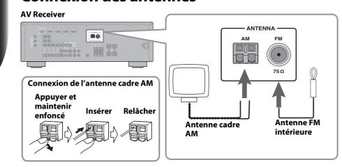
Raccordez l'antenne cadre AM ((D)) et l'antenne FM intérieure ((E)) à l'AV Receiver, de la façon illustrée. Reportez-vous aux différents modes d'emploi pour en savoir plus sur la connexion des antennes.
