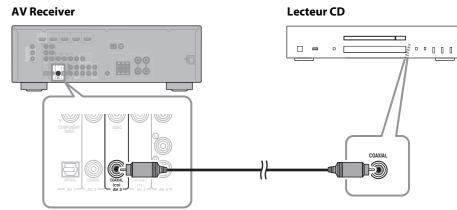
Utilisez un câble coaxial numérique (non fourni) pour relier le lecteur CD à la prise AV 3 COAXIAL (CD) de l'AV Receiver, de la façon illustrée.
