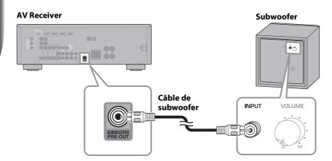
Utilisez le câble de subwoofer fourni ((J)) pour relier la prise INPUT du subwoofer à la prise SUBWOOFER PRE OUT de l'AV Receiver.
