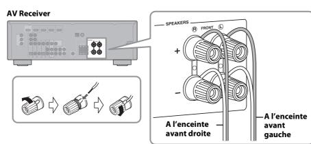
Connectez les câbles de l'enceinte avant (⑤) sur l'AV Receiver. Faites attention à la polarité lorsque vous raccordez les enceintes —bornes positives (+) aux bornes positives (+), et bornes négatives (-) aux bornes négatives (-).
