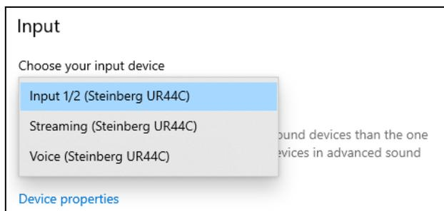
Lors de l'utilisation d'une application DAW, etc., une boucle de feedback du signal peut se produire avec la fonction Track Monitor, etc. Il est donc important de vérifier soigneusement les réglages de l'application que vous utilisez.
