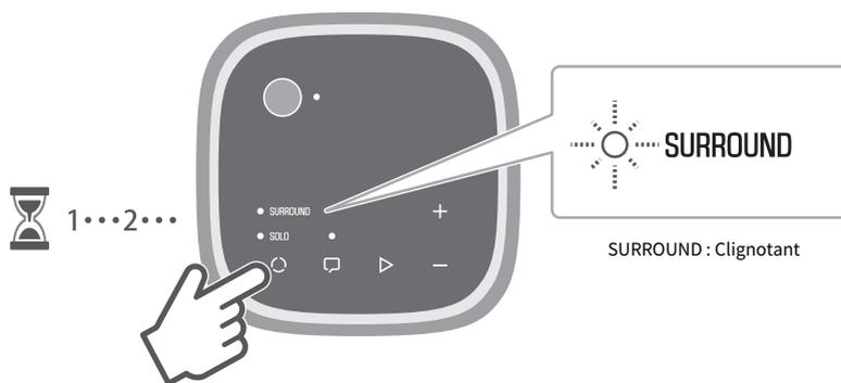
À l'étape suivante, utilisez les commandes de la barre de son. Utilisez les commandes de la barre de son dans les deux minutes qui suivent le passage de l'enceinte sans fil au statut d'attente d'enregistrement.
