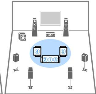
Mesures multiples (1 position d'écoute + avant/arrière/gauche/droite)
