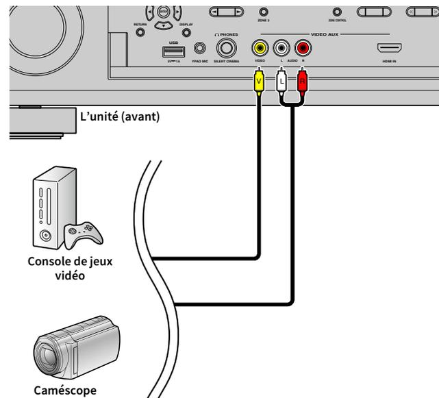
Si vous appuyez sur V-AUX pour sélectionner la source d'entrée « V-AUX », les signaux vidéo/audio lus par l'appareil vidéo seront restitués sur l'unité.
