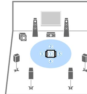
Mesures multiples (2 positions d'écoute + avant/arrière)
