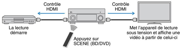
Pour utiliser le contrôle HDMI, vous devez procéder au réglage de la liaison du contrôle HDMI suivant après avoir raccordé le téléviseur et les appareils de lecture.
