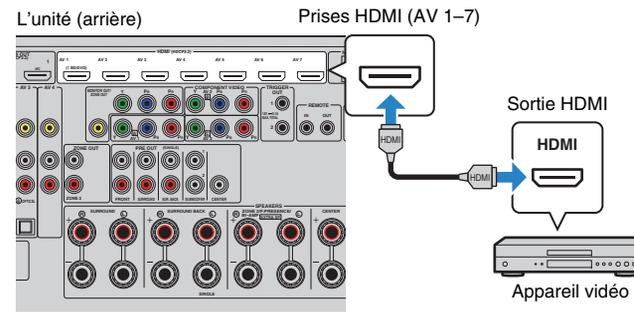
Si vous appuyez sur AV 1-7 sur la télécommande pour sélectionner la source d'entrée, les signaux vidéo/audio lus par l'appareil vidéo seront restitués sur l'unité.
