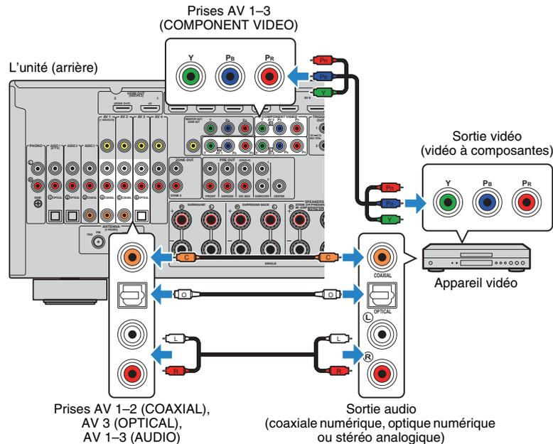
Si vous appuyez sur AV 1-3 sur la télécommande pour sélectionner la source d'entrée, les signaux vidéo/audio lus par l'appareil vidéo seront restitués sur l'unité.
