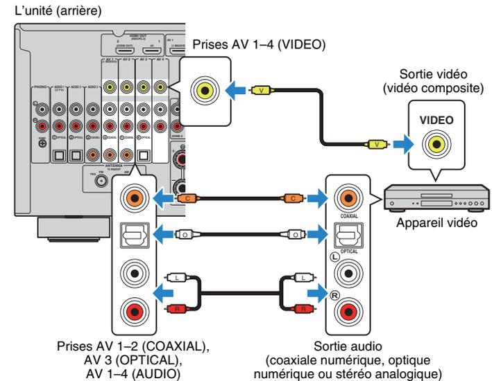
Si vous appuyez sur AV 1-4 sur la télécommande pour sélectionner la source d'entrée, les signaux vidéo/audio lus par l'appareil vidéo seront restitués sur l'unité.
