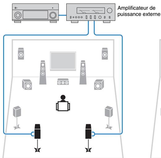
**Utilisation des amplificateurs intégrés supplémentaires pour les enceintes stéréo dans une autre pièce**
