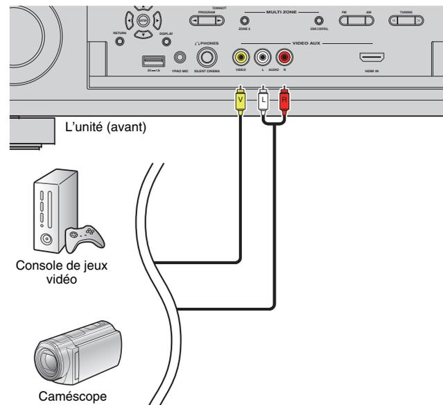
Si vous appuyez sur V-AUX pour sélectionner la source d'entrée « V-AUX », les signaux vidéo/audio lus par l'appareil seront restitués sur l'unité.
