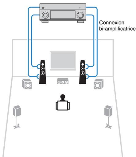
**Combinaison d'un amplificateur de puissance externe (amplificateur hi-fi ou autre) pour créer un système étendu**
