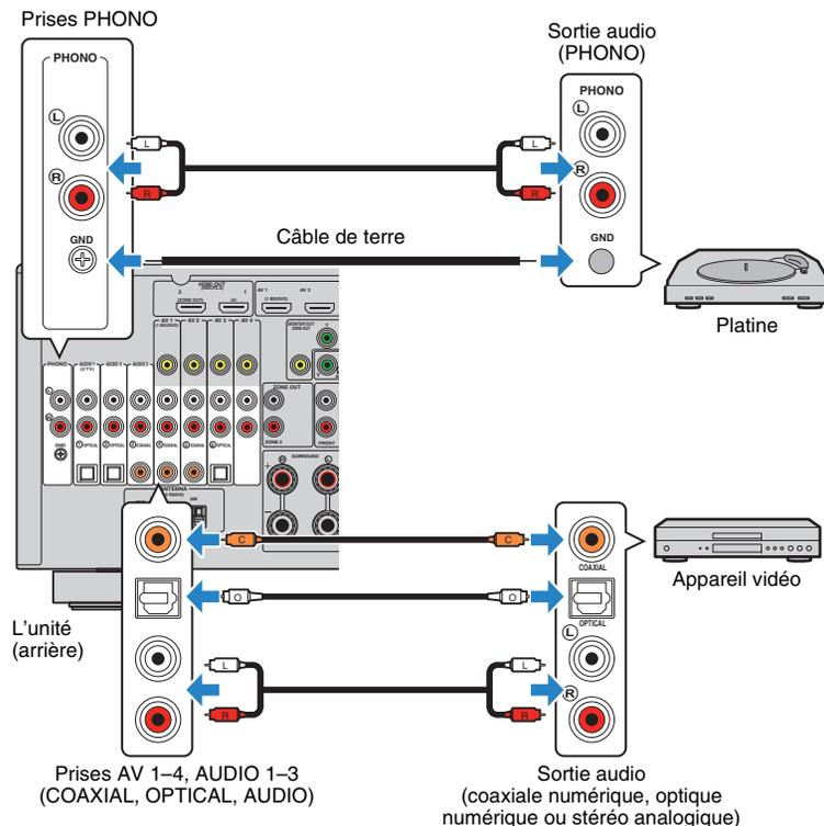
Si vous appuyez sur AV 1-4, AUDIO 1-3 ou sur PHONO sur la télécommande pour sélectionner la source d'entrée, les signaux audio lus par l'appareil audio seront restitués sur l'unité.
