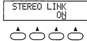
Lorsque cette fonction est mise ON (en utilisant les touche [▲] et [▼] ou la touche de fonction située sous OFF), l’éditio du paramètre d’un canal donnera automatiquement la même valeur au même paramètre de l’autre canal. Mettre la fonction STEREO LINK OFF lorsqu’il est souhaitable de programmer des valeurs différentes aux paramètres du canal droit et à ceux du canal gauche.
