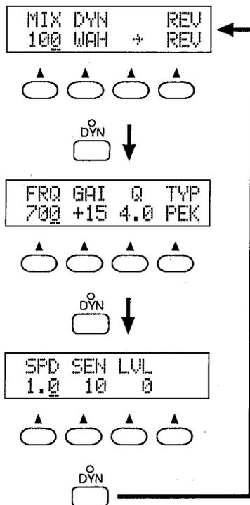
Chaque écran contient jusqu'à quatre paramètres. L'abréviation de chaque paramètre apparaît sur la ligne supérieure de l'affichage
