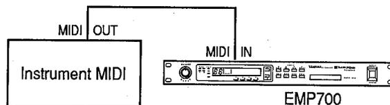
Afin de pouvoir utiliser ce type de montage, les deux "contrôleurs" permis par l'EMP700 doivent être réglés de manière à pouvoir recevoir des données de changement de commande MIDI (c'est-à-dire: recevoir les données transmises par un contrôleur MIDI spécifique) à l'aide de la fonction "MIDI CONTROL" décrite ci-dessous.
