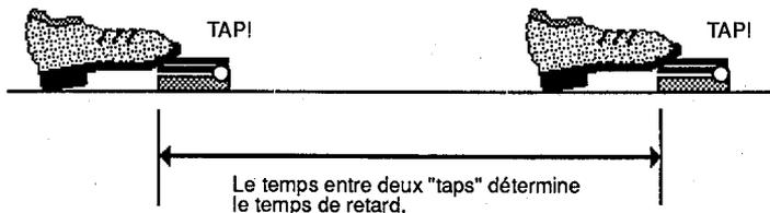
Dans le cas des programmes comprenant des paramètres de retard de canal gauche et de canal droit, la fonction TAP TEMPO de la pédale détermine directement le temps du paramètre de retard du canal gauche, alors que le paramètre de retard de canal droit est réglé différemment selon que la différence entre les temps de retard de canal gauche et de canal droit est inférieur ou supérieur à 50 ms.
