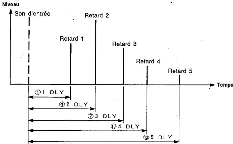
La position stéréo des retards 1 à 5 est déterminée par le paramètre PAN correspondant.
