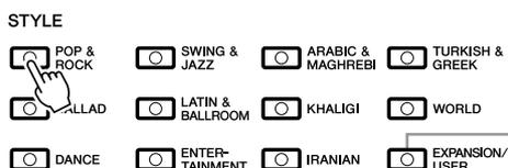
La touche [EXPANSION/USER] est utilisée pour appeler des styles personnalisés (styles que vous avez créés avec la fonction Style Creator (Créateur de styles)) ou des styles Expansion (styles installés en plus). Les styles Expansion peuvent être installés en suivant la même procédure que pour les voix Expansion. Pour plus de détails, reportez-vous à la section « Extension des voix » (page 39).
