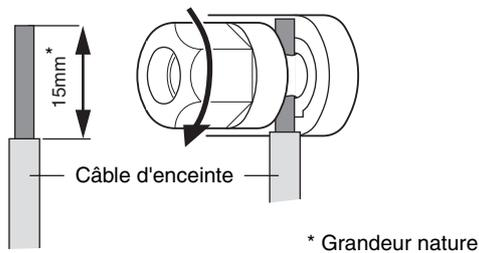
Vérifiez que les extrémités dénudées des fils ne dépassent pas des bornes et ne touchent pas le châssis. L'illustration suivante indique la manière correcte de fixer le fil dénudé.
