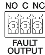
Le connecteur [FAULT OUTPUT] (page 71) est constitué des broches NO (Normally Open (Normalement ouvert)), C (Common (Commun)) et NC (Normally Closed (Normalement fermé)). Le connecteur [FAULT OUTPUT] est un circuit relais qui fonctionne comme suit.
