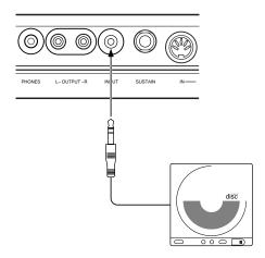
3. Remettez le CBX-K1XG sous tension et augmentez progressivement le volume sur le CBX-K1XG (et le niveau de sortie de la source, si nécessaire) jusqu'à ce que le niveau soit approprié.
