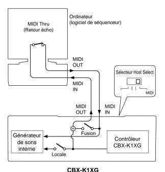
\* Activez le réglage MIDI Thru (ou Retour écho) sur le logiciel de l'ordinateur et désactivez les fonctions de fusion MIDI et locale sur le CBX-K1XG, pour éviter une
