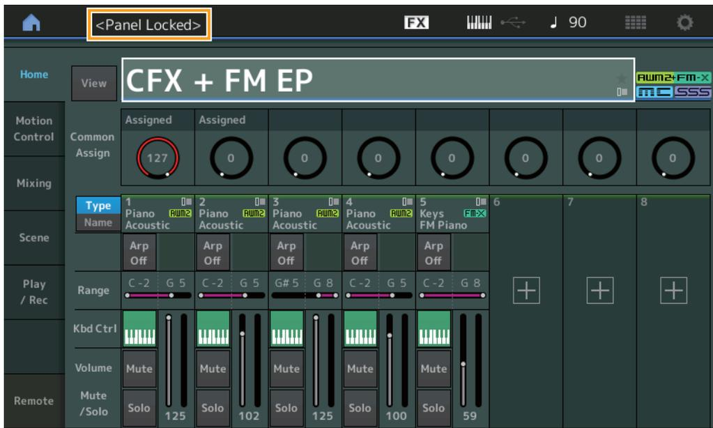
Pour déverrouiller le panneau, appuyez à nouveau sur [SHIFT] + [ELEMENT COMMON]. Lorsque la fonction Panel Lock est activée, la plupart des opérations sont indisponibles, à l'exception des opérations liées au clavier, aux pédales, au volume principal, à Super Knob, à la molette de variation de ton, à la molette de modulation et à l'opération de déverrouillage. Le verrouillage s'applique également aux opérations liées à l'écran tactile.
