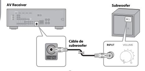
Utilisez le câble de subwoofer fourni ((1)) pour relier la prise INPUT du subwoofer à la prise SUBWOOFER PRE OUT de l'AV Receiver.
