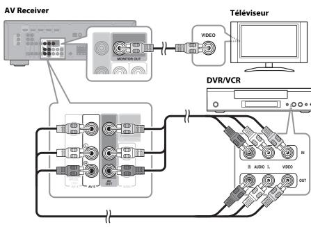
Utilisez un câble vidéo RCA/cinch (non fourni) pour relier la prise MONITOR OUT de l'AV Receiver à une entrée vidéo composite du téléviseur, de la façon illustrée.
