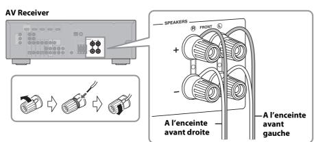
Connectez les câbles de l'enceinte avant (F) sur l'AV Receiver. Faites attention à la polarité lorsque vous raccordez les enceintes —bornes positives (+) aux bornes positives (+), et bornes négatives (-) aux bornes négatives (-).
