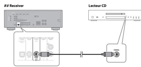
Utilisez un câble coaxial numérique (non fourni) pour relier le lecteur CD à la prise AV 3 COAXIAL (CD) de l'AV Receiver, de la façon illustrée.
