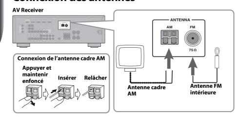
Raccordez l'antenne cadre AM (©) et l'antenne FM intérieure (D) à l'AV Receiver, de la façon illustrée. Reportez-vous aux différents modes d'emploi pour en savoir plus sur la connexion des antennes.
