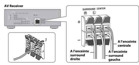
Raccordez les câbles de l'enceinte centrale (⑤) et de l'enceinte surround (F) à l'AV Receiver. Faites attention à la polarité lorsque vous raccordez les enceintes —bornes positives (+) aux bornes positives (+), et bornes négatives (-) aux bornes négatives (-).
