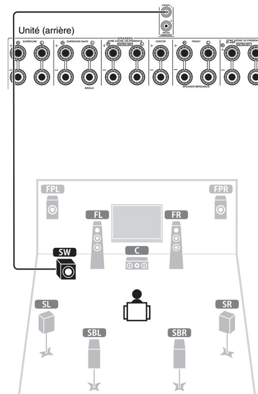
Utilisez un câble de broche audio pour raccorder le caisson de graves (**SW**).
