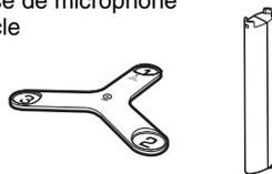
\*Utilisé pendant le YPAO pour la mesure des angles/de la hauteur.
