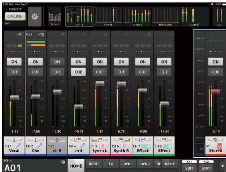
Vous pouvez passer en mode SENDS ON FADER en appuyant sur le numéro de canal sur le côté gauche d'une bande. Le canal sélectionné apparaît alors en surbrillance dans la couleur du canal. Appuyer sur EXIT tout en bas, ou sur le numéro de canal sélectionné, pour rétablir le mode normal.
