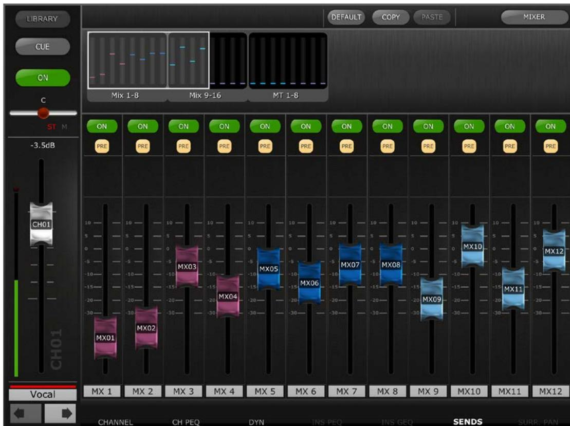
Utilisez le bandeau de bargraphes pour procéder au balayage horizontal permettant d'afficher les envois Mix/Matrix porteurs de numéros supérieurs ou inférieurs.
