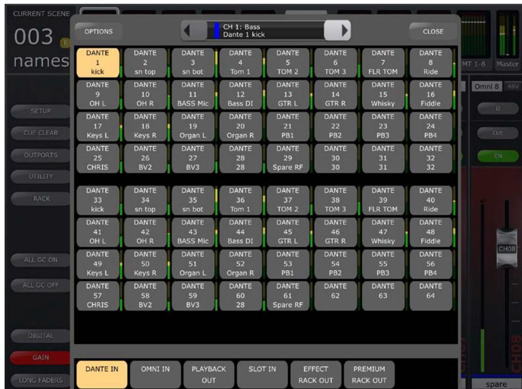
Le numéro et le nom du canal sélectionné s'affichent sur la ligne supérieure de la fenêtre, tout en haut de la vue. Au-dessous se trouve le port d'entrée actuellement appliqué.
