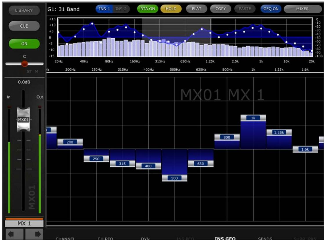
Le nom, la couleur, le fader, les indicateurs de niveau et les touches [ON] et [CUE] affectés au canal actuellement sélectionné s'affichent dans la colonne de gauche. Des touches fléchées apparaissent dans le coin inférieur gauche, qui permettent de naviguer entre les différents canaux « précédent » et « suivant ». En appuyant sur ces touches, vous accédez uniquement aux autres canaux auxquels des égaliseurs graphiques ont été affectés.
