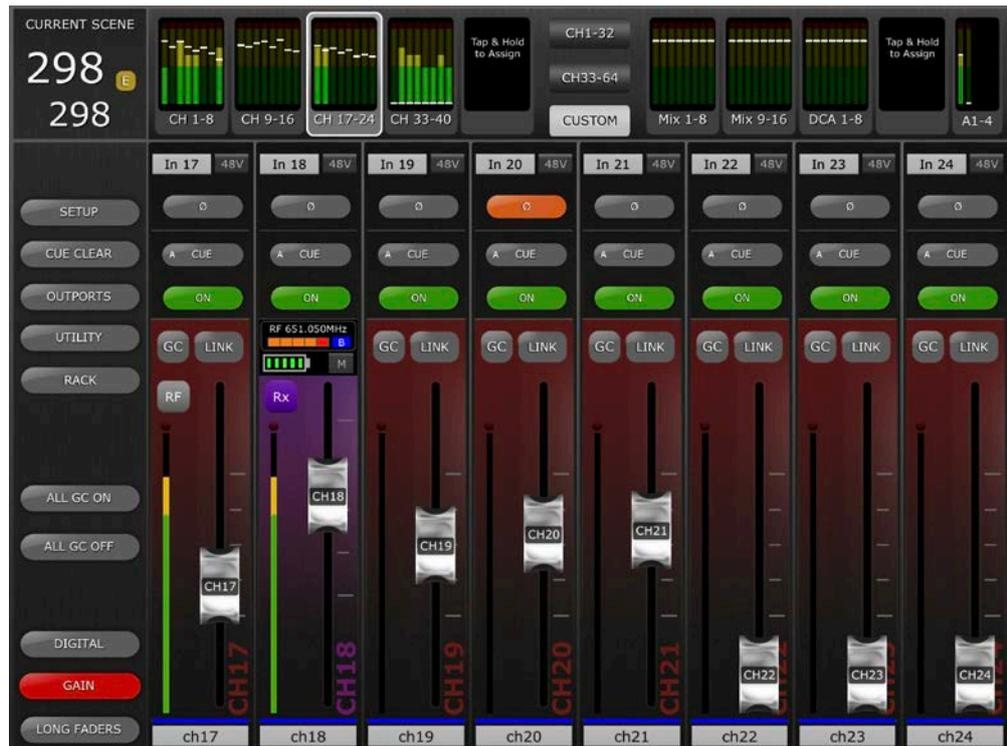
Appuyez sur cette touche pour basculer la bande de canaux HA sur la vue de commande et de contrôle RF. La bande de canaux apparaît en violet pour indiquer qu'elle affiche à présent un canal RF, et la touche située au-dessus de l'indicateur de niveau affiche RX pour indiquer que le fader HA commande désormais le gain RX.
