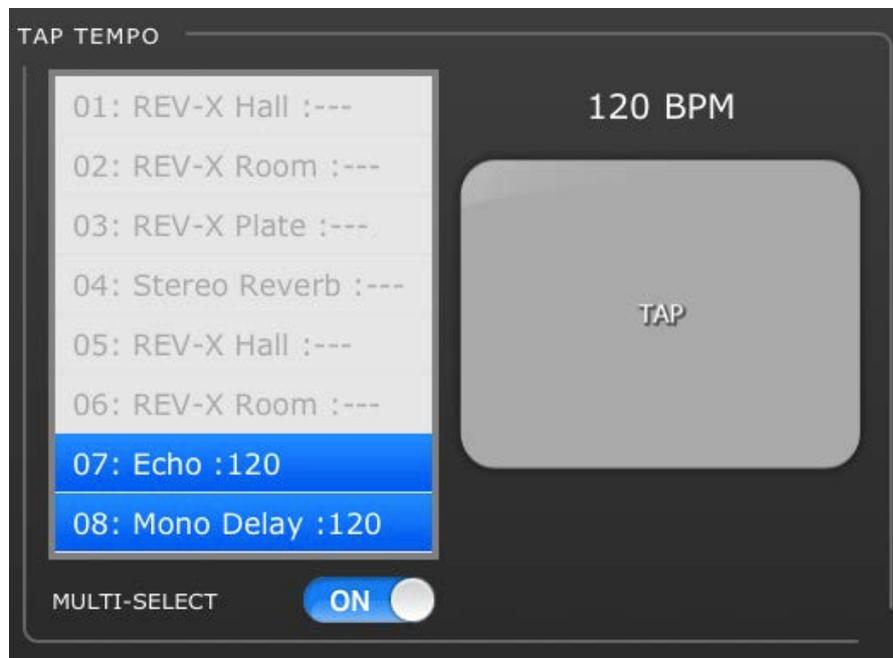
Sélectionnez l'effet pertinent dans la liste des 8 effets située à gauche de cette section. Les effets ne comportant pas de paramètre BPM sont grisés et ne peuvent pas être sélectionnés.
