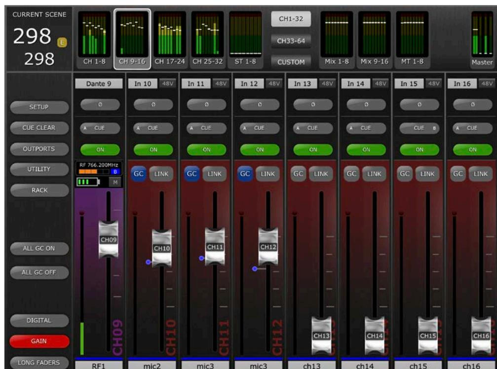
Le fader commande le gain de sortie du canal lié au récepteur sans fil (RX). L'état actuel de la pile du microphone sans fil s'affiche au-dessus du fader. L'état Mute (Assourdissement) de la sortie audio du récepteur s'affiche à droite du témoin de charge (si celui-ci est disponible sur le récepteur sans fil). Touchez ici pour assourdir ou activer la sortie du récepteur. Une fenêtre contextuelle de confirmation s'affiche alors.
