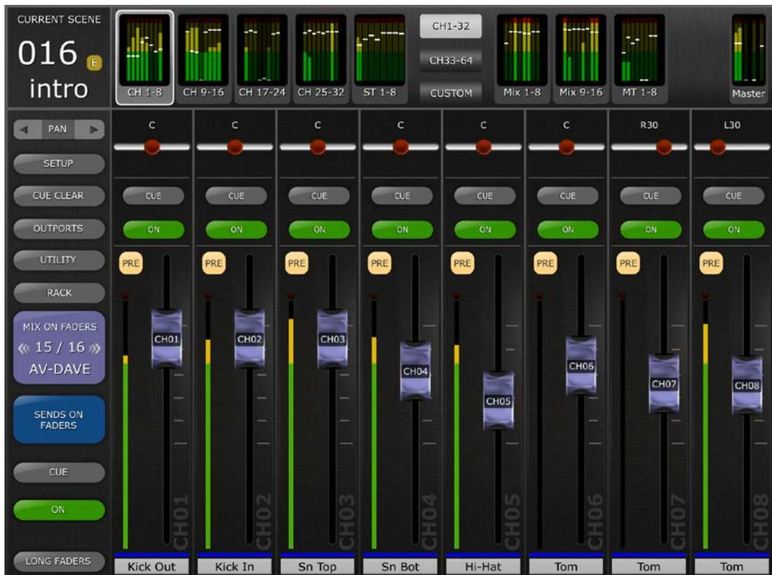
Une large touche [MIX ON FADERS] (Mixage de faders activé) affiche le numéro et le nom du bus Mix ou Matrix actuellement sélectionné. La couleur de cette touche correspond à celle des touches utilisées sur la console de série QL.
