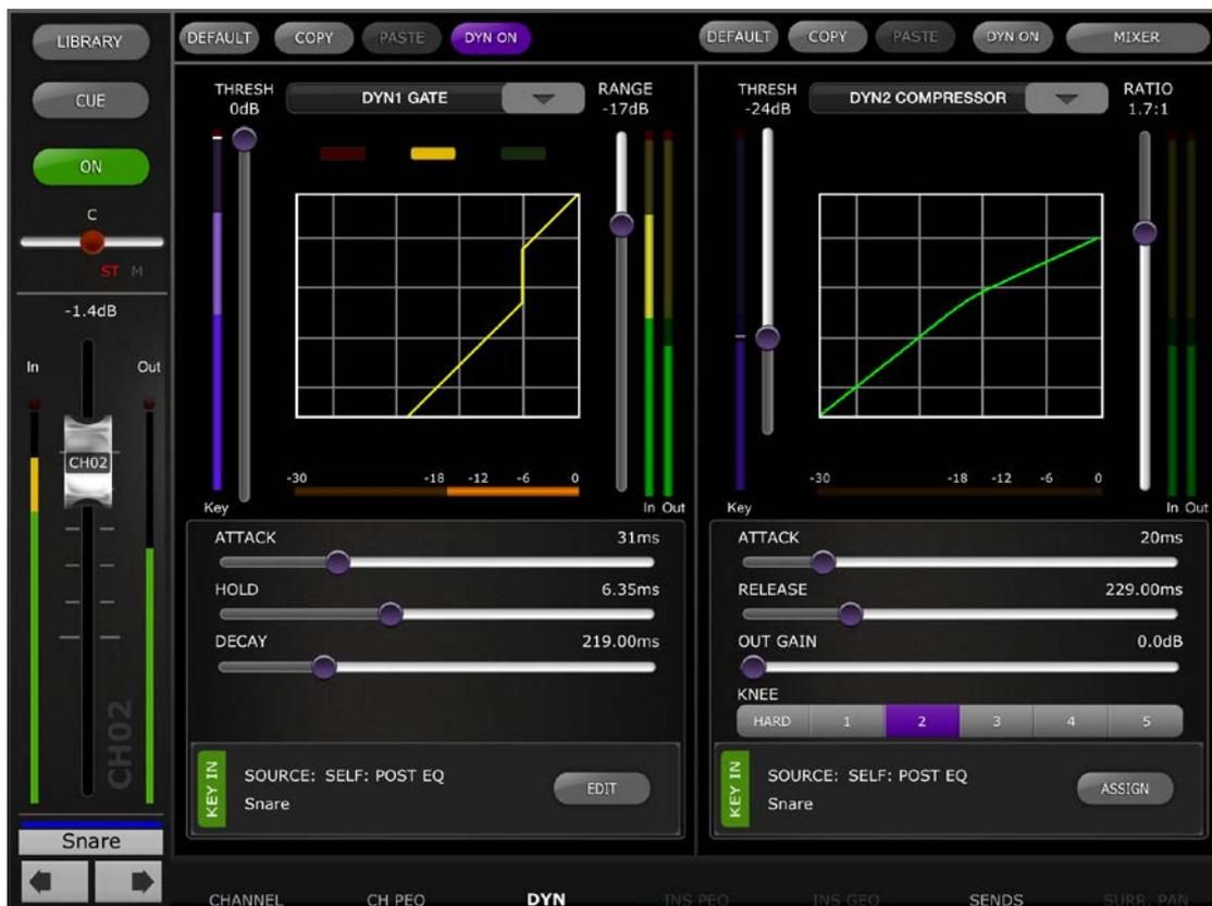
Le volet gauche de cet écran (Channel Strip) est identique à l'écran EQ Editing (Édition EQ) et comporte les éléments suivants : fader de canal, touche On (Activation), touche Cue, indicateurs de niveau d'entrée et de sortie, nom de canal, et touches de couleur et de navigation.
