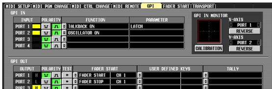
Si vous spécifiez le même port pour les paramètres FADER START et FADER STOP, le champ FADER START de l'écran GPI sera affecté au canal correspondant à ce port (Mode Fader= FADER TALLY). (L'inverse est également vrai.)
