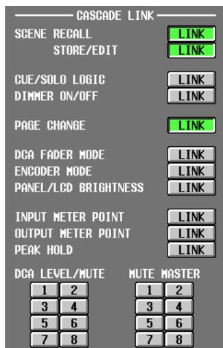
Les réglages de la zone CASCADE LINK sélectionnent les opérations qui sont liées lorsque plusieurs PM5D sont connectés en cascade. Vous pouvez sélectionner les éléments suivants.
