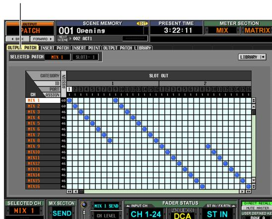
La section OUTPUT PATCH vous permet d'affecter les canaux de sortie aux ports de sortie. La direction horizontale de l'écran montre les ports de sortie (comme par exemple les destinations de patch) et la direction verticale de l'écran indique les canaux de sortie (comme par exemple les sources de patch).
