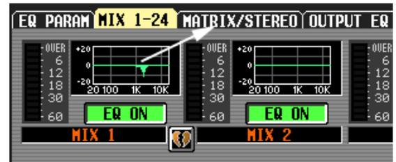
Vous pouvez également copier des réglages entre l'EQ à huit bandes d'un canal MIX ou STEREO A/B et l'EQ à quatre bandes d'un canal MATRIX. Dans ce cas, seules les quatre bandes LOWER sont copiées pour les canaux MIX ou STEREO A/B.
