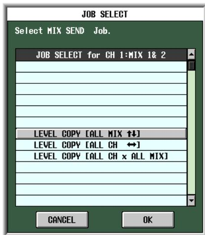
Pour régler plusieurs paramètres à la fois, utilisez l'encodeur [DATA] pour sélectionner un des éléments suivants et cliquez sur la touche OK.
