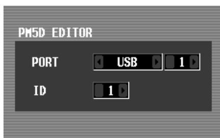
Utilisez tout d'abord le champ PORT pour sélectionner le port qui sera utilisé pour communiquer avec l'ordinateur. Cliquez sur les touches [←] / [→] situées à gauche et à droite de la zone de gauche pour sélectionner le type de port et appuyez sur la touche [ENTER] (ou cliquez dans la zone) pour valider votre sélection. Si vous sélectionnez USB ou SLOT 1-4, utilisez la zone de droite pour sélectionner un numéro de port 1-8.
