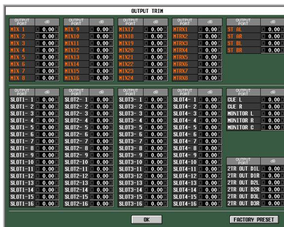
Pour régler le gain, cliquez sur les touches ◀ / ▶ situées à gauche et à droite de chaque zone pour spécifier le gain de chaque port de sortie en unités de 0,01 dB. Pour réinitialiser tous les ports de sortie sur 0,00 dB, cliquez sur la touche FACTORY PRESET. Cliquez sur OK pour appliquer les réglages.
