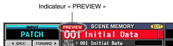
En mode PREVIEW, le fonctionnement des boutons, encodeurs et autres commandes (exception faite pour les sections TALKBACK, CUE/MONITOR et AD IN du PM5D) n'a aucune incidence sur le traitement des signaux audio.
