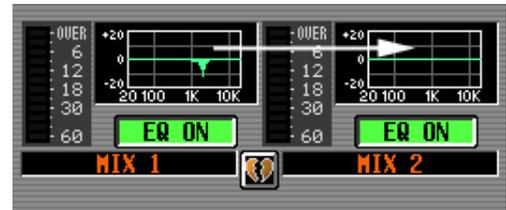
Vous pouvez également copier des réglages EQ entre les écrans MIX 1-24 et MATRIX/STEREO. Faites d'abord glisser le mini-graphique sur l'onglet MIX 1-24 ou MATRIX/STEREO de l'écran (l'écran bascule). Déposez-le ensuite sur le canal souhaité. Un message vous demande de confirmer l'opération de copie.
