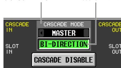
Lorsque plusieurs PM5D sont connectés en cascade, les réglages de la zone CASCADE MODE spécifient si l'unité agit en tant que maître de la cascade (si « MASTER » est sélectionné) ou en tant qu'esclave (si « SLAVE » est sélectionné).
