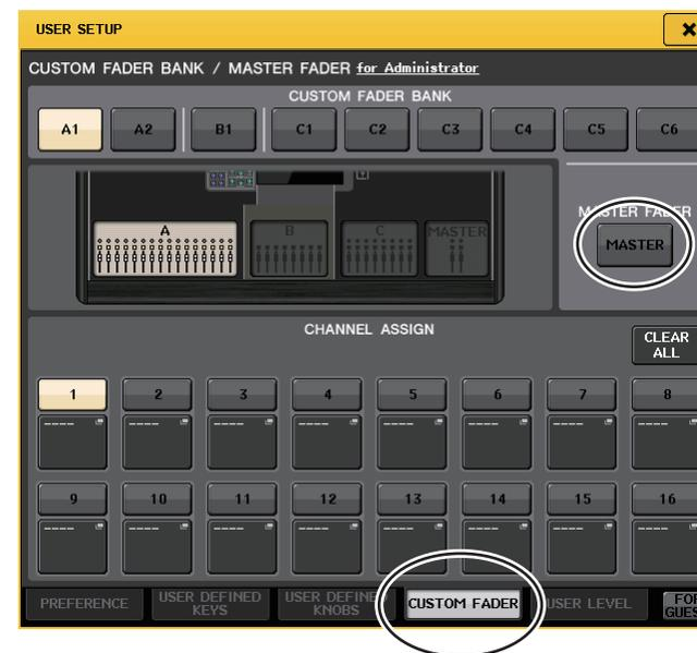
3. Appuyez sur l'onglet CUSTOM FADER pour accéder à la page CUSTOM FADER BANK/MASTER FADER.
