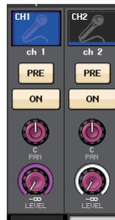
Si la source de l'envoi est en stéréo, vous pourrez utiliser le réglage du mode PAN/BALANCE dans la fenêtre contextuelle TO STEREO/MONO pour spécifier si PAN/BALANCE servira de bouton PAN ou de bouton BALANCE.
