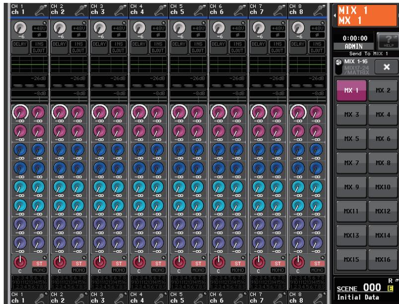
3. Appuyez de manière répétée sur la touche de commutation MIX/MTRX ON FADER pour sélectionner MIX1–16 ou MIX17–24/MATRIX.
