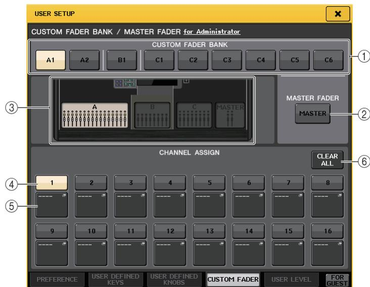
3. Appuyez sur l'onglet **CUSTOM FADER** (Fader personnalisé) accéder à la page **CUSTOM FADER BANK/MASTER FADER** (Banque de faders personnalisés/Fader principal).
