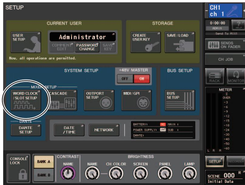
2. Dans le champ **SYSTEM SETUP** au centre de l'écran, appuyez sur la touche **WORD CLOCK/SLOT SETUP** pour ouvrir la fenêtre contextuelle **WORD CLOCK / SLOT SETUP**.
