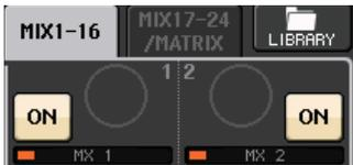
Si le bus MIX de destination de l'envoi est de type VARI ou si la destination de l'envoi est un bus MATRIX, le bouton TO MIX SEND LEVEL s'affichera sous une couleur identique à celle du bouton correspondant dans la section SELECTED CHANNEL. Dans ce cas, vous pourrez utiliser le bouton correspondant de la section SELECTED CHANNEL pour régler le niveau d'envoi.
