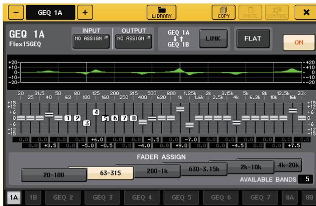
Cette fenêtre est identique à celle de l'égaliseur 31BandGEQ, hormis le fait que la zone de paramètre AVAILABLE BANDS (Bandes disponibles) indique le nombre en temps réel de bandes supplémentaires (15 au maximum) pouvant être contrôlées dans le GEQ actuellement sélectionné. Dans le cas d'un rack dans lequel un égaliseur Flex15GEQ est monté, les onglets de basculement entre les racks sont divisés en xA et xB (x étant le numéro de rack).
