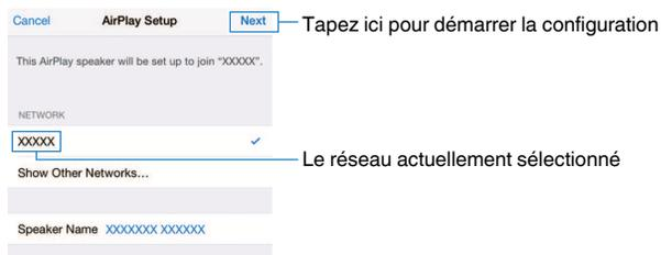
Une fois le partage terminé, l'unité se connecte automatiquement au réseau sélectionné (point d'accès) et « Completed » apparaît sur l'afficheur de la face avant.
