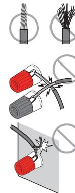
Si « Check SP Wires » apparaît sur l'afficheur de la face avant à la mise sous tension de l'unité, éteignez-la, puis vérifiez que les câbles d'enceinte ne sont pas court-circuités.
