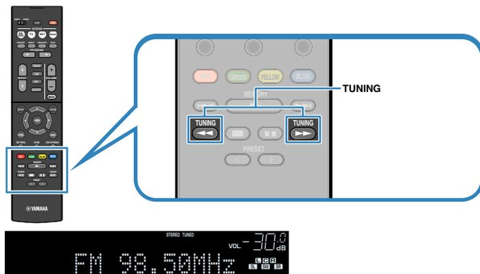
« TUNED » s'allume lorsque l'unité reçoit un signal provenant d'une station de radio.
