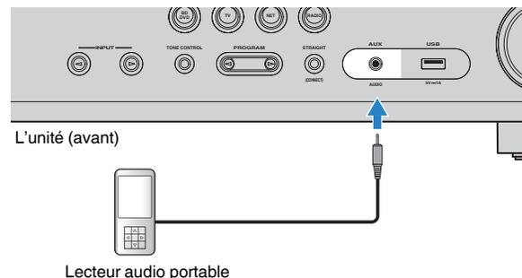
Si vous sélectionnez la source d'entrée « AUX » en appuyant sur INPUT, les signaux audio lus par l'appareil seront restitués sur l'unité.
