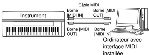
La deuxième possibilité de connexion passe par une interface MIDI externe séparée reliée à l'ordinateur via un port USB ou un port série (borne du modem ou de l'imprimante). A l'aide de câbles MIDI standard, branchez la borne MIDI OUT de l'interface externe à la borne [MIDI IN] de l'instrument et branchez la borne [MIDI OUT] de l'instrument à la borne MIDI IN de l'interface.
