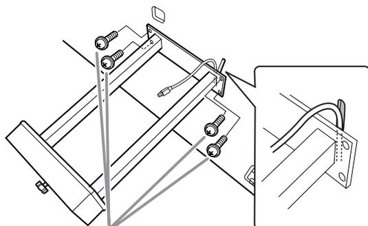
6 x vis de fixation de 20 mm
