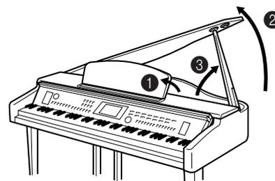
Pour activer l'iAFC (page 76), ouvrez le couvercle avec le bras long en utilisant le renforcement intérieur. Lorsque le couvercle est fermé ou ouvert avec le bras court, il est impossible d'activer l'iAFC.
