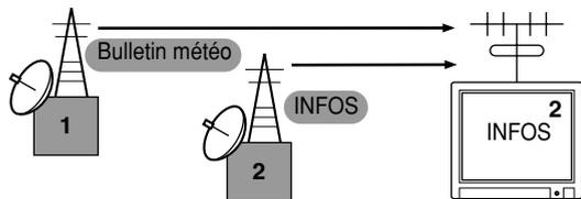
La norme MIDI fonctionne selon le même principe de base. L'instrument émetteur envoie des données MIDI sur un canal MIDI spécifique (canal de transmission MIDI) via un câble MIDI unique à l'instrument récepteur. Si le canal MIDI de l'instrument récepteur (canal de réception MIDI) correspond au canal de transmission, le son émis par l'instrument récepteur dépendra des données envoyées par l'instrument émetteur.
