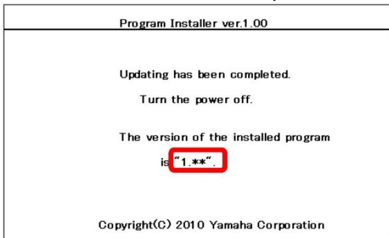
Schalten Sie das Instrument nun aus und entfernen Sie den USB-Stick.
