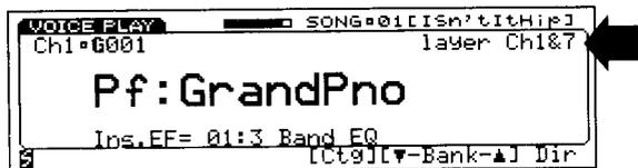
Les deux numéros Track superposés sont indiqués sur l'écran. Pour changer la sonorité superposée (la seconde), il suffit de maintenir la touche (Shift) et d'appuyer sur une autre touche Track.
