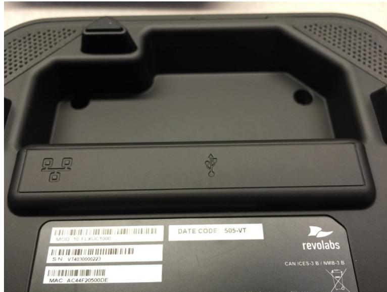
Connectez une extrémité du câble Ethernet au port de connexion réseau au niveau de la partie inférieure de l'unité. Le port est indiqué par l'icône représentée ci-dessous. Appuyez sur le câble jusqu'à ce qu'un déclic confirme sa mise en place.
