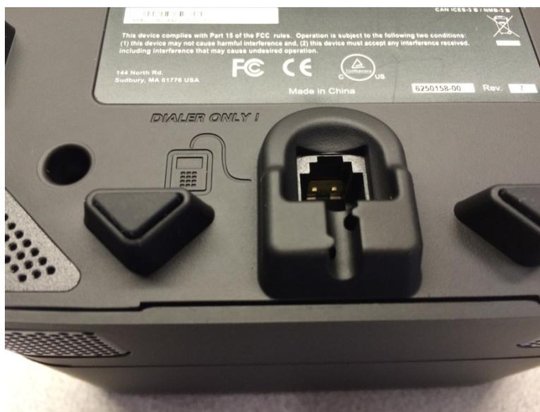
Prenez le câble du composeur et insérez le connecteur du câble dans l'orifice « Dialer Only » jusqu'à ce qu'un déclic confirme sa mise en place.
