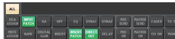
Questa figura indica che i parametri INPUT PATCH, INSERT PATCH e DIRECT OUT sono stati impostati su Safe mediante le impostazioni del parametro Global per INPUT PATCH.
