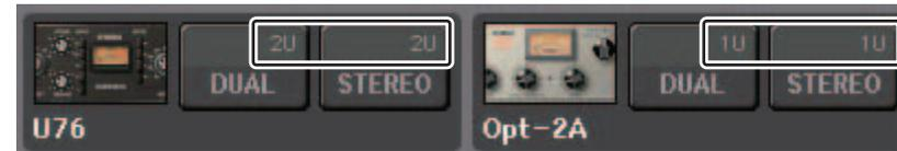
Il tipo U76 occupa due unità di spazio rack. Gli altri processori occupano una unità di spazio rack. Se si monta un processore Premium Rack da due unità di spazio nel rack, non sarà possibile montare alcun altro processore sotto a tali unità di spazio rack. Non è inoltre possibile montare un processore da due unità in rack con numeri pari.
