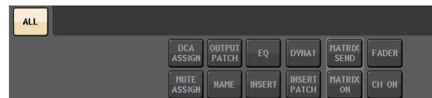
Se la funzione Recall Safe è attivata per i parametri globali, i pulsanti di selezione del parametro di blocco del canale selezionato si illumineranno nel colore verde, come mostrato di seguito.
