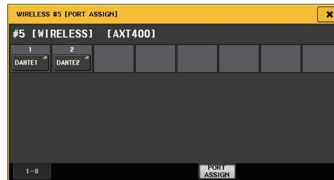
Ad esempio: collegamento dell'uscita di un dispositivo Shure AXT400 a OMNI 1 su una console CL e assegnazione del segnale al canale di ingresso 1.
