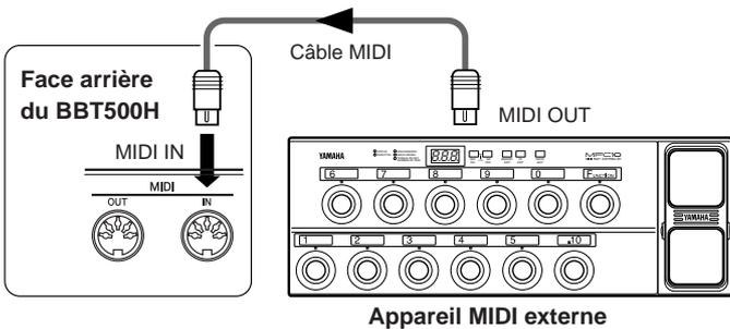
2 Paramétrez le canal de réception MIDI sur le BBT500H et le canal d'émission MIDI sur l'appareil externe en utilisant le même numéro de canal MIDI. Canal sélectionné par défaut : 1)
