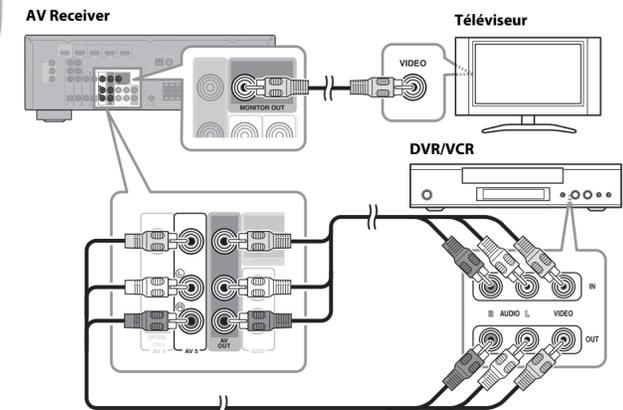
Utilisez un câble vidéo RCA/cinch (non fourni) pour relier la prise MONITOR OUT de l'AV Receiver à une entrée vidéo composite du téléviseur, de la façon illustrée.
