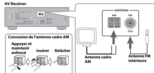
Raccordez l'antenne cadre AM (D) et l'antenne FM intérieure (E) à l'AV Receiver, de la façon illustrée. Reportez-vous aux différents modes d'emploi pour en savoir plus sur la connexion des antennes.
