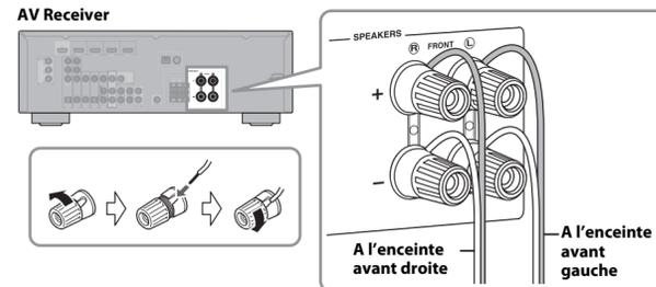
Connectez les câbles de l'enceinte avant (G) sur l'AV Receiver. Faites attention à la polarité lorsque vous raccordez les enceintes — bornes positives (+) aux bornes positives (+), et bornes négatives (-) aux bornes négatives (-).
