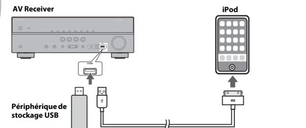
Connectez un périphérique de stockage USB ou un câble USB fourni avec l'iPod sur la prise USB de l'ampli-tuner audio-vidéo (en façade), de la façon illustrée.
