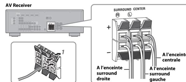
Raccordez les câbles de l'enceinte centrale (H) et de l'enceinte surround (C) à l'AV Receiver. Faites attention à la polarité lorsque vous raccordez les enceintes — bornes positives (+) aux bornes positives (+), et bornes négatives (-) aux bornes négatives (-).
