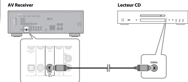
Utilisez un câble coaxial numérique (non fourni) pour relier le lecteur CD à la prise AV 3 COAXIAL (CD) de l'AV Receiver, de la façon illustrée.
