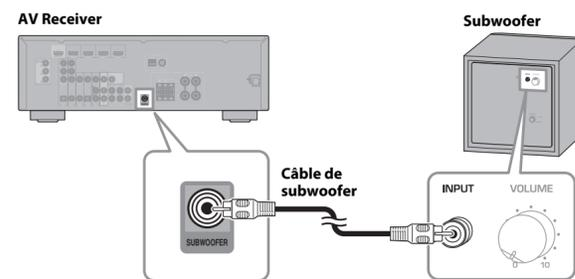
Utilisez le câble de subwoofer fourni (J) pour relier la prise INPUT du subwoofer à la prise SUBWOOFER de l'AV Receiver.
