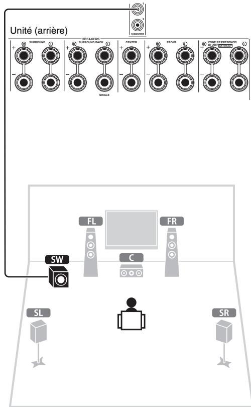
Utilisez un câble de broche audio pour raccorder le caisson de graves (**SW**).
