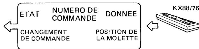
Au moment d'utiliser CONTROL CHANGE (changement de commande), il faut introduire ce deuxième octet. En d'autres termes, on choisit la nouvelle identité du régulateur. La donnée de changement de commande MIDI apparaît dans la note 3 de ce manuel, à la page 28.
