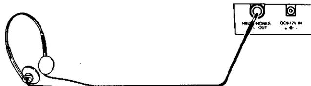
Pour raccorder un amplificateur de clavier ou stéréo : (en utilisant un amplificateur de clavier ou stéréo, le son global sera vraiment mis en valeur). Raccordez un cordon de connexion entre la prise HEADPHONES/AUX. OUT et les entrées LINE IN, AUX IN, etc., de l'amplificateur de clavier ou stéréo.
