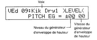
Résumé: Détermine la "forme" du générateur d'enveloppe de hauteur pour la voix sélectionnée.
