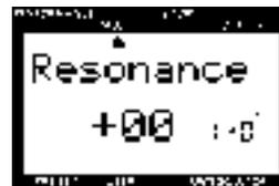
En général, les filtres modifient le timbre en laissant passer les signaux compris dans une plage de fréquence définie et en coupant les signaux en dehors de cette plage. Le CS2x comprend un filtre passe-bas laissant passer les signaux en-dessous du point de coupure défini (ou "fréquence de coupure") et coupant les signaux au-delà de ce point de coupure.
