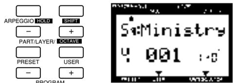
A chaque pression sur la touche [PRESET] ou [USER], le CS2x passe respectivement de la banque P1 à la banque P2 ou de la banque U1 à la banque U2. Le nom de la banque de performance sélectionnée est indiqué à l'affichage, à gauche du numéro de performance.
