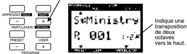
**REMARQUE** La valeur de transposition définie sera également appliquée au paramètre de transposition de clavier Kbd Trans du mode UTILITY. Notez que vu que la plage de réglage maximum est de  $\pm 3$  octaves, lorsque vous augmentez ou diminuez la transposition de clavier par pas de demi-ton, le paramètre de décalage d'octave ne pourra vous fournir la plage complète de trois octaves.
