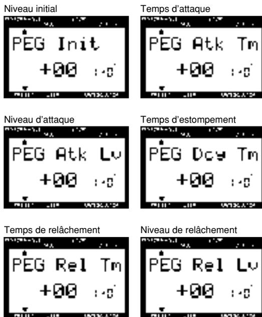
**INIT LEVEL (niveau initial) :** Ce paramètre définit le niveau de hauteur initial lorsque la note est jouée.
