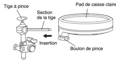
3. Si nécessaire, utilisez les boulons de pince A à E pour régler la hauteur et l'angle du pad de caisse claire. Prenez soin d'ajuster les boulons un par un (desserrez un boulon, ajustez le pad, puis resserrez le boulon avant d'en desserrer un autre).
