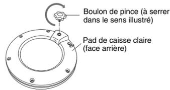
2. Montez le pad de caisse claire sur la tige à pince du rack. Vérifiez que la section de la tige est entièrement insérée dans l'orifice de montage du pad, ainsi qu'illustré ci-dessous, puis serrez à fond le boulon de pince.
