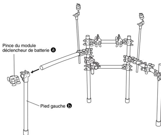
2. Assemblez la pince pour le support de cymbale charleston, en veillant à l'orienter comme illustré sur la figure, puis remontez le pied gauche **b** et la pince du module déclencheur de batterie **a**.
