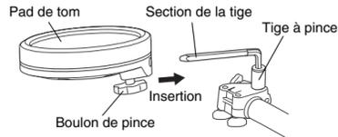
3. Si nécessaire, utilisez les boulons de pince A à D pour régler la hauteur et l'angle des pads. Prenez soin d'ajuster les boulons un par un (desserrez un boulon, ajustez le pad, puis resserrez le boulon avant d'en desserrer un autre).
