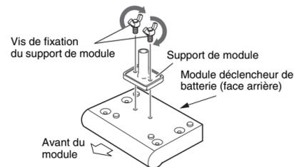
2. Placez le support de module à l'intérieur de la pince de support et serrez le boulon de pince pour le maintenir en place.
