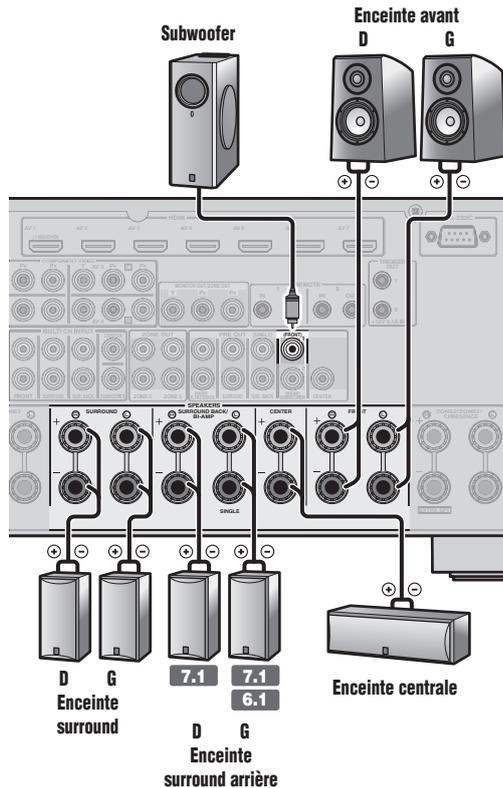
**7.1** Raccordez lors de l'utilisation avec un système d'enceintes à 7.1 voies.
