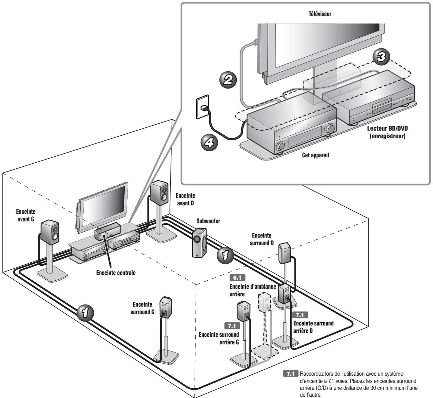
**7.1** Raccordez lors de l'utilisation avec un système d'enceinte à 7.1 voies. Placez les enceintes surround arrière (G/D) à une distance de 30 cm minimum l'une de l'autre.
