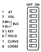
Utilisez le tournevis du WX7 pour régler ces commutateurs. Prenez soin de bien replacer le tournevis sur son support après utilisation. Pour chaque commutateur DIP tourner sur la gauche pour la position OFF, sur la droite pour la position ON.
