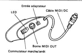
Le bloc MIDI/Batterie fournit le courant nécessaire (9 volts en continu) au WX7 et envoie les données MIDI du WX7 à votre synthétiseur ou générateur de sons MIDI. Le bloc MIDI/Batterie fonctionne normalement sur 6 piles format "AA". Vous pouvez également utiliser un adaptateur 12 volts en option (Yamaha PA-1). Une troisième possibilité consiste à utiliser des piles rechargeables. Dans ce cas, nous vous suggérons d'avoir toujours des piles de rechange déjà chargées à porté de la main.
