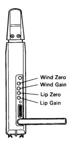
Pour chacun de ces points, tourner dans le sens des aiguilles d'une montre augmente la valeur du paramètre et tourner dans le sens inverse des aiguilles d'une montre diminue la valeur du paramètre. Utilisez le tournevis pour régler ces points (prenez soin de replacer le tournevis à sa place après utilisation).
