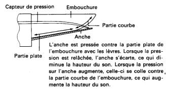
Il y a une étroite zone "neutre" au centre où de légers changements dans la pression exercée par les lèvres ne font pas varier la hauteur. Cette zone "neutre" permet de rester plus facilement au diapason. LIP ZERO fixe la position de la zone "neutre" controle. Le niveau auquel l'anche répond à la pression des lèvres peut être réglé (paramètre LIP GAIN). Reportez-vous à la section "AJUSTEMENT DE LA RE-PONSE MUSICALE" pour plus de détails sur la manière de régler ces paramètres.
