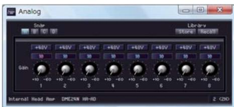
Par défaut, le gain est réglé sur +10dBu (C.-à-d. le niveau le plus bas possible). Ajustez la sensibilité au bon niveau pour l'équipement audio connecté.
