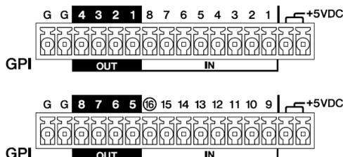
Le DME7 comporte 16 bornes d'entrée et 8 bornes de sortie.
